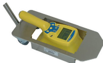
CoMo eingesetzt in einer Fußbodenkontrollvorrichtung
