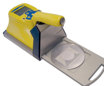
CoMo in a smear test measuring station
