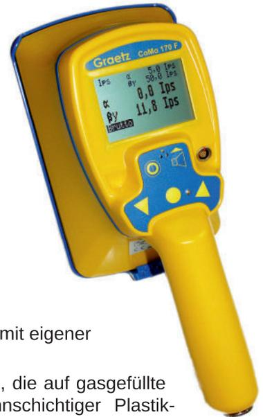
Ein wesentlicher Vorteil des CoMo-170/CoMo-170 F ist die Detektortechnologie, die auf gasgefüllte oder gasgespülte Detektoren komplett verzichtet. Eingesetzt wird ein dünnemschichtiger Plastik-Szintillationsdetektor mit ZnS-Beschichtung. Damit ist es möglich, mit einem Detektor  $\alpha$ -,  $\beta$ - und  $\gamma$ -empfindlich zu messen. Bei mechanischer Zerstörung der Detektorfolie kann der Austausch der Folie problemlos vom Kunden selbst durchgeführt werden.
