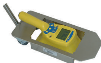
CoMo eingesetzt in einer Fußbodenkontrollvorrichtung
