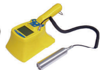
CoMo mit angeschlossenem Detektor zur Dosisleistungsmessung
