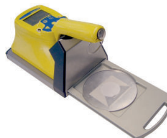
CoMo in a smear test measuring station
