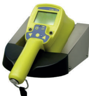
stationärer Einsatz des CoMo-Systems in aktiver Wandstation
