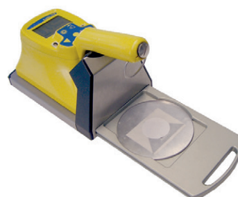
CoMo in a smear test measuring station
