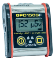
Alarmdosimeter GPD150GF Warnschwellen: 1, 20, 100, 250 mSv
