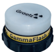
Dosisleistungswarngeräte GammaFlash, GammaTest F und GWL10m Warnschwelle für Absperrbereich: 25 µSv/h
