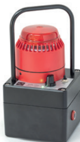
Dosisleistungswarngeräte GammaFlash, GammaTest F und GWL10m Warnschwelle für Absperrbereich: 25 µSv/h
